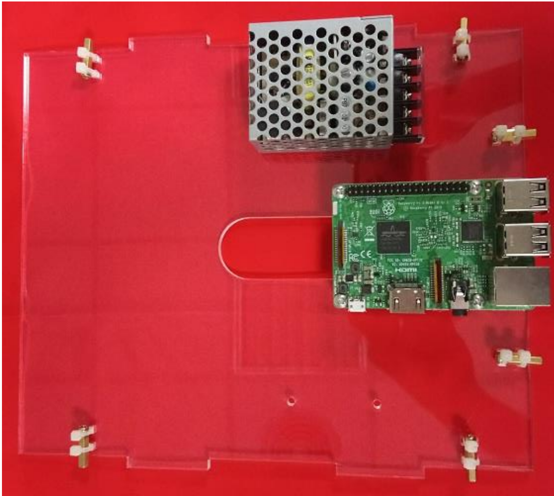
圖 8 底板組裝(電源 2 x M3*8、樹莓派 8 x M3*8、銅柱)
