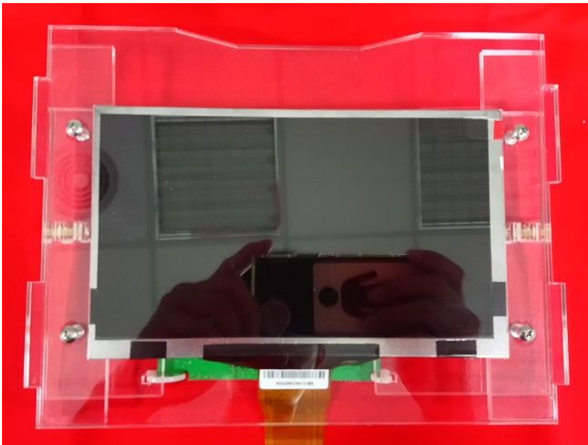
圖 18&19 以螺絲(4 x M3*20)、螺母固定
