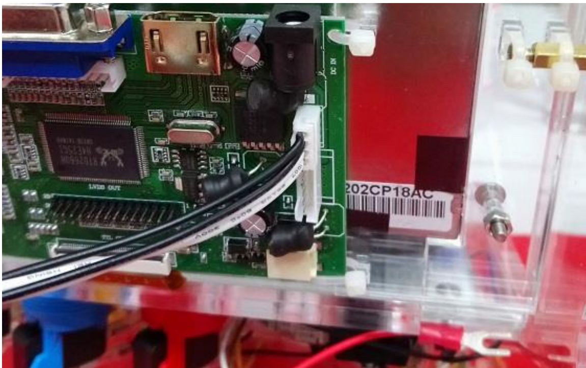
圖 27 螢幕轉接板插入電源、HDMI 線(圖上沒插請插入)
