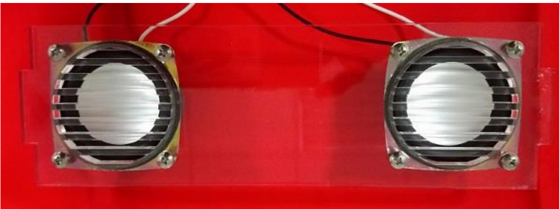
圖 6&圖 7 喇叭組裝圖(8 x M3*12x 螺絲&螺母)
