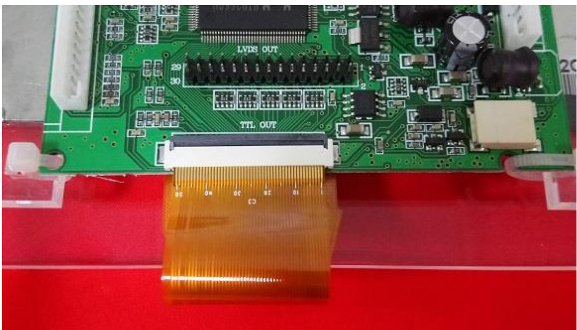
圖 20、21、22 FPC 接頭上扳，插入軟排線，在下扳，完成
