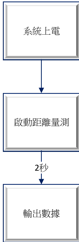
圖 5. CLDR-08SB 動作流程
