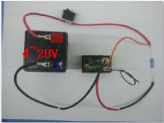
1A或10電壓電流錶接線圖
