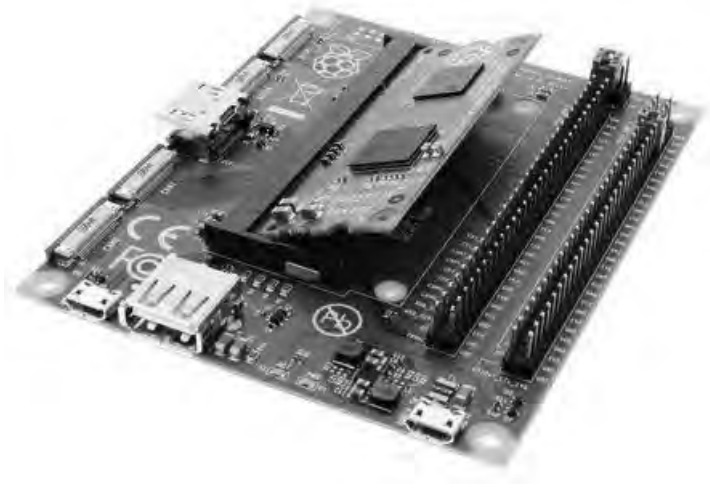
圖 1-17 Raspberry Pi Compute Module 樹莓派電腦模組外觀
